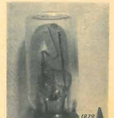
Fig. 13. - Starter bimetallico del tipo a luminescenza.
